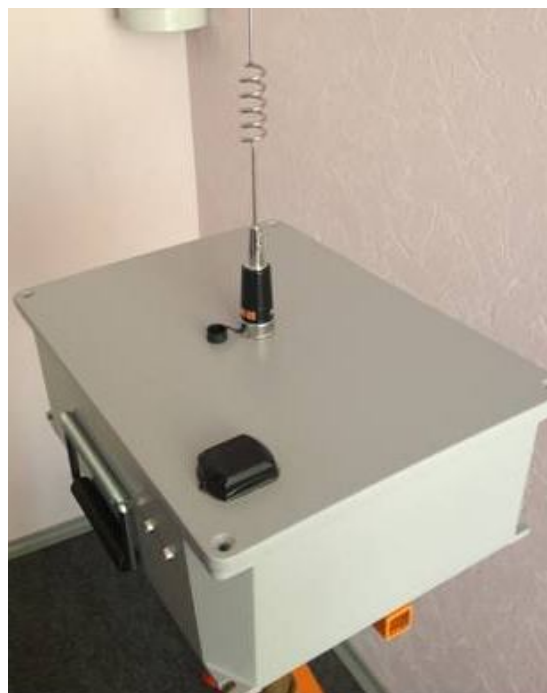
Рисунок 1.3 – Вид соединителя и не подключенной УКВ антенны (слева) и закрепленной магнитной антенны ГЛОНАСС/GPS (справа)
