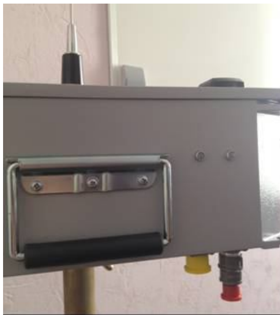
Рисунок 1.9 – Фрагмент боковой (лицевой) панели блока ПМК с ручкой для переноски блока и светодиодными индикаторами
