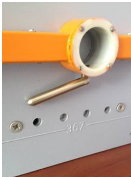
Рисунок 1.7 - Внешний вид фрагмента нижней стенки блока ПМК с технологическими отверстиями для забора воздуха на датчики АХОВ
